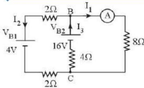
٣- في الدائرة الكهربائية الموضحة بالشكل، أوجد قراءة الأميتر (A) مع إهمال المقاومة الداخلية للبطاريتين ( $V_{B1}$  و  $V_{B2}$ ).
